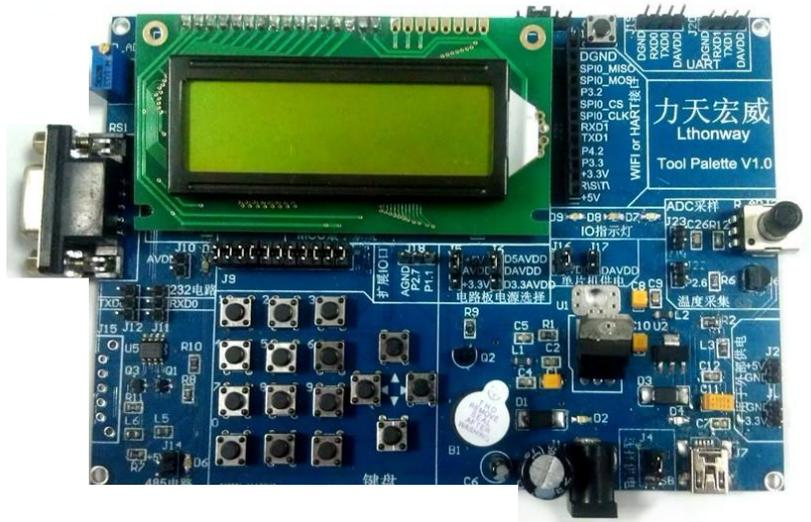
新唐 ARM Cortex™-M0 内核的 32 位微控制器 M054LAN 的高性能保证整块开发板外设的稳定性。丰富的外设接口也为外部应用的高扩展性和高定制性奠定了基础。可选择型 RS232、RS485 电平转换电路为同上位机进行通信提供了便捷, 液晶显示屏可通过软件设置时刻观测外设运行状态, 温度采集以及 ADC 采样为模拟采集提供了硬件基础, 可通过引出的 UART 引脚同外部直接进行数据传输, 矩阵按键、蜂鸣器、LED 等为单片机的学习提供了丰富的外设, 也可作为供电源为外部提供 5V 或 3.3V 电压, 充分利用了单片机所有接口及引脚资源, 不论为单片机的学习或是基础电路板的需要都提供了便利。
